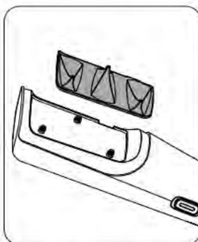
Retire el campo de boquillas y límpielo a fondo bajo el agua corriente con un jabón suave presionando y frotando.
