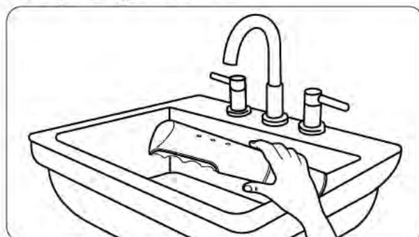
Apunte el dispositivo IONIQ ONE hacia un lavabo (recipiente vacío). Mantenga pulsados los dos botones de disparo (IQ y parpadeo). Mantenga los botones de disparo accionados hasta que el líquido salga rociado por las tres boquillas durante al menos 5 segundos.
