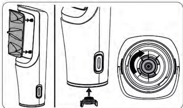
Deje secar completamente todas las piezas del IONIQ ONE antes de volver a montarlo. Vuelva a colocar el adaptador de cartucho y el campo de boquillas. Presione cada una de las boquillas hacia abajo para que el conjunto de boquillas esté totalmente encajado y se asiente completamente enrasado en el dispositivo.
