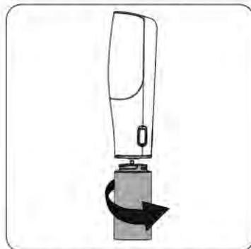
Alinee las lengüetas en la parte inferior de la unidad con la parte superior del cartucho. Enrosque el cartucho hasta que sienta que encaja en su sitio.
