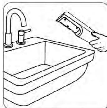
Sostenga el dispositivo sin el campo de boquillas dentro de un lavabo, enciéndalo y mantenga pulsados los dos botones de disparo simultáneamente durante varios segundos. A continuación, vuelva a apagarlo.
